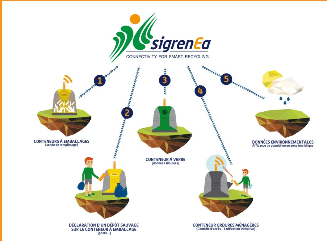
**1** EMBALLAGES, le conteneur équipé d'une sonde de télémessure remonte deux fois par jour le niveau de remplissage afin d'optimiser la collecte et éviter les débordements.
